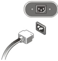
**Abbildung 5. Netzanschlüsse**
