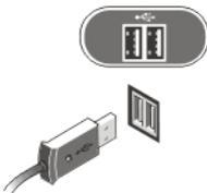
**Abbildung 4. Tastatur- und Mausanschluss**
