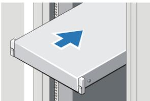
**Abbildung 2. Rack-Installation**
